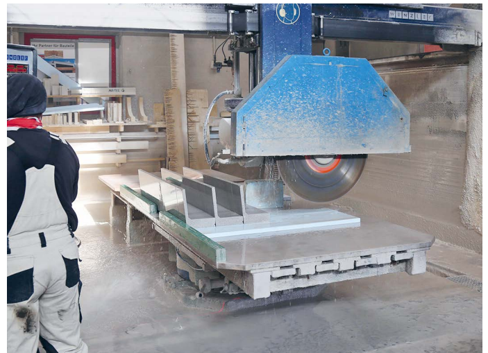
Massgeschneidert für jedes Gebäude: dünnwandige Fassadenelemente aus glasfaserverstärktem Beton.
